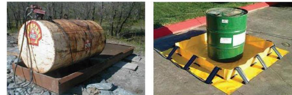
Exemples de bac de rétention
